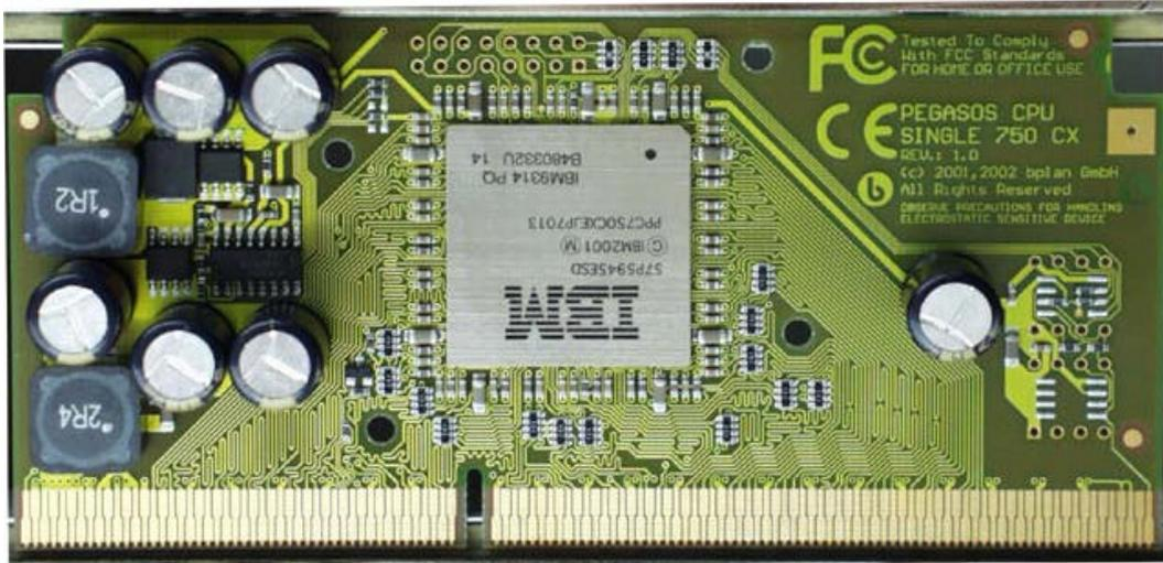
Les modules processeur G4 sont équipés d'un ventilateur, alors qu'aucun système de refroidissement n'est nécessaire pour les G3.
